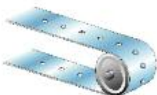
Fig. 5 Trasmissione positiva con cinghia forata e puleggia dentata
