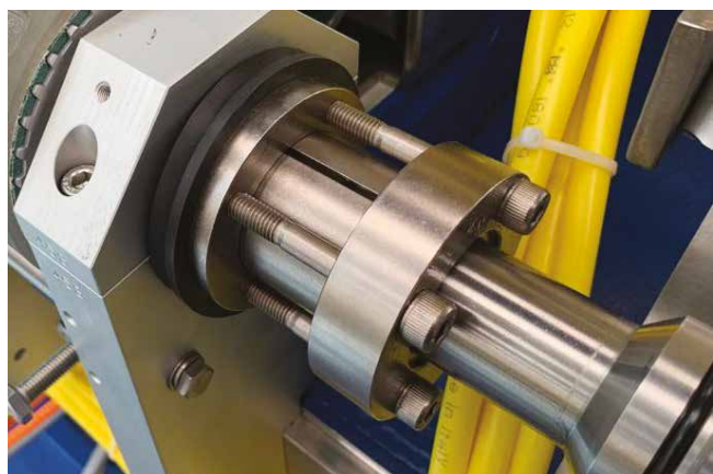
Bloccaggio di due alberi tramite SIT-LOCK® 10 versione nichelata.
