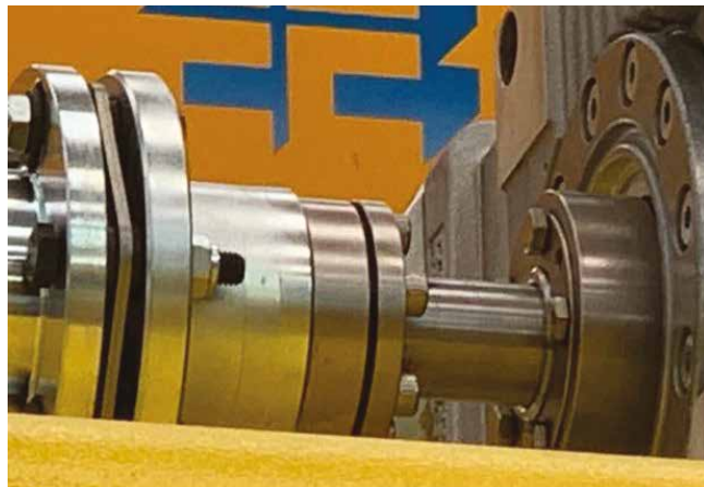
SIT-LOCK® 3 applicato per il bloccaggio di un giunto a lamelle.
